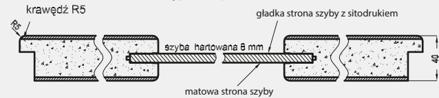
Przekrój poziomy drzwi VETRO C5 i C8-C10
