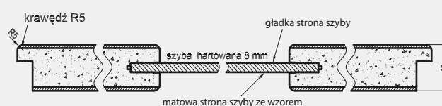
Przekrój poziomy drzwi VETRO A5, A8-A11
