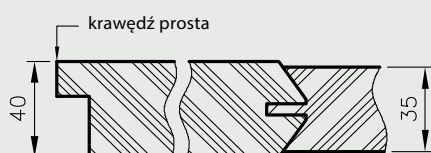
Przekrój poziomy drzwi Elsa
