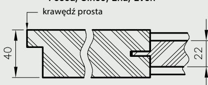
Przekrój poziomy drzwi Auri, Emena, Verano, Piano, Premium, Fosca, Sinco, Ena, Even
