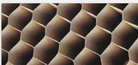
(A) Wkład stabilizujący „plaster miodu”
