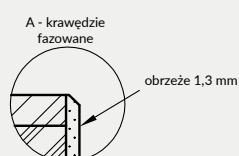
Przekrój ramiaka skrzydła bezprzylgowego
